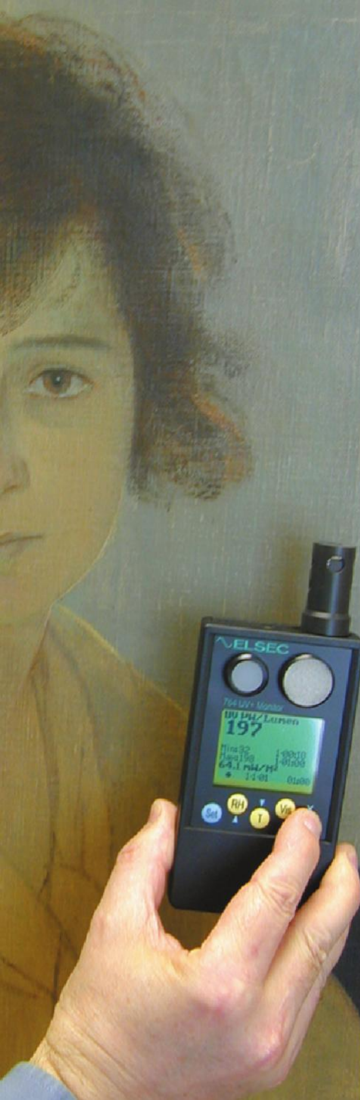
Licht- en klimaatmeting, Depot voor kunstwerken van de Vlaamse Gemeenschap te Schaarbeek. © FARO
